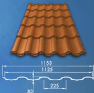
Имеет максимальное сходство со средиземноморской глиняной черепицей. Отличается прочностью, применяется в загородном строительстве и в реставрации старой кровли.
