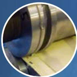
Клеть с просечными ножами пробивает монтажные отверстия по краю панели.
