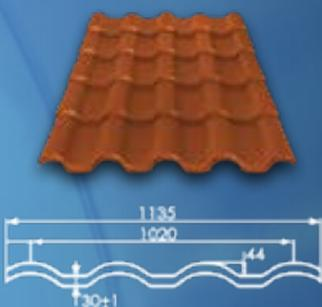
В данном изделии учтены все геометрические изъязны металлочерепицы вида «Монтеррей», а именно: увеличена высота профиля, следовательно, повышена устойчивость к атмосферным воздействиям, улучшено качество замковых соединений, стыковые соединения практически не видны.
